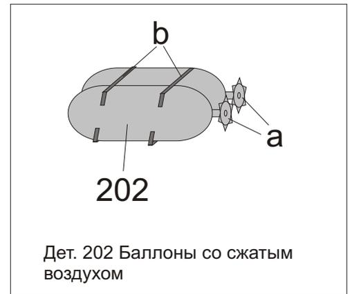
Дет. 202 Баллоны со сжатым воздухом
